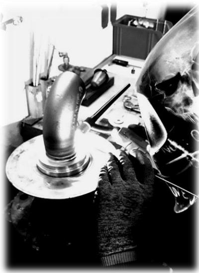
Unsere ausgebildeten Fachkräfte übernehmen Ihre Schweißarbeiten für Stahl und Edelstahl. Wir garantieren hochwertige und saubere Schweißnähte für eine dauerhafte Verbindung. Wir sind der richtige Produzent für Klein- und Großteile - Einzel- und Serienfertigung. Wir schweißen hauptsächlich im WIG-Schweißen Verfahren.
