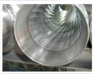
Wir fertigen die Zweilagenschlauchleitungen aus den Werkstoffen W.1.4404 / W.1.4301 in den Nennweiten DN 50 bis DN 150 in Längen bis zu 10 Meter. Trotz des zweilagigen Aufbaus sind ausgezeichnete Biegeradien möglich, die von Gummischläuche kaum erreicht werden.
